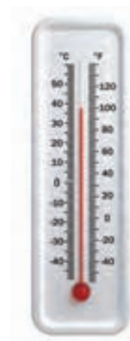
شکل ۱-۴ یک نمونه دماسنج الکلی
