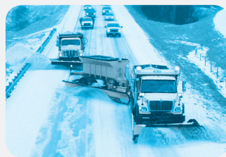
به کارگیری ماشین برف روب مجهز به می پراس جاده ای برای پاک سازی جاده ها - کانادا
