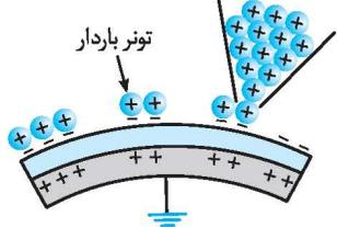
در مرحله بعد، پودر باردار را از روی غلتک عبور می‌دهند که جذب قسمت‌های باردار می‌شوند.
