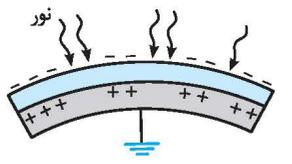
هنگامی که برگه را روی سطح شیشه‌ای دستگاه قرار می‌دهند، نور شدیدی به آن تابانده می‌شود. قسمت‌های سفید رنگ کاغذ، نور را بازتاب می‌کنند ولی قسمت‌های تیره رنگ که شامل نوشته یا تصویر هستند، تقریباً بازتاب ناچیزی دارند. نورهای بازتاب‌شده پس از برخورد با بخش رسانای روی غلتک باعث خنثی شدن بار آن قسمت‌ها می‌شوند.
