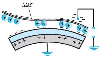
در مرحله آخر، کاغذ سفید که به صورت ناهم‌نام با پودر سیاه، باردار شده است را از روی آن عبور می‌دهند تا پودر سیاه را جذب می‌کند.
