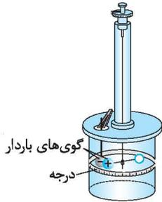
اجسام باردار به یکدیگر نیروی جاذبه و دافعه وارد می‌کنند که به آن نیروی الکتریکی می‌گویند. دانشمند فرانسوی، شارل آگوستین کولن با استفاده از یک ترازوی پیچشی، عوامل مؤثر بر نیروی بین دو جسم باردار کوچک را مشخص کرد.
