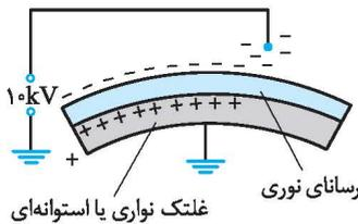
اساس کار دستگاه کپی باردار شدن و نیروی بین اجسام باردار است.
