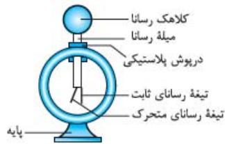
شکل رو به رو ساختمان یک الکتروسکوپ را نشان می‌دهد. همان طور که می‌بینید، الکتروسکوپ دو تیغه دارد که یکی ثابت و دیگری متحرک است. وقتی الکتروسکوپ بدون بار است، تیغه‌های آن کاملاً به هم نزدیک هستند؛ اما، وقتی که الکتروسکوپ باردار می‌شود، تیغه‌های آن از هم دور می‌شوند.
